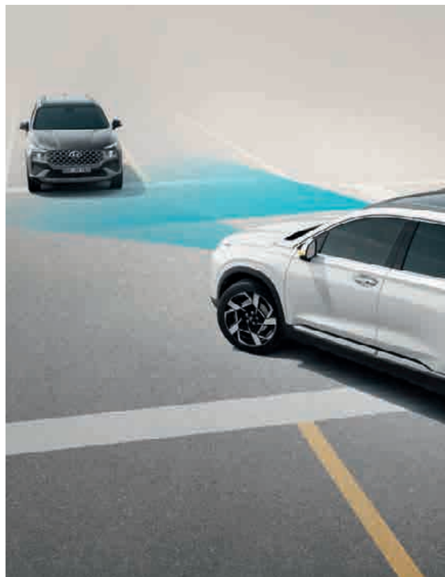
Autonomní nouzové brzdění (FCA, odbočování v křižovatkách) Systém FCA vás varuje a automaticky zahajuje brzdění, jestliže zaznamená náhlé zpomalení vozidla jedoucího před vámi nebo zjistí, že v jízdní dráze vašeho vozidla se nacházejí chodci nebo cyklisté. Totéž platí pro nebezpečí kolizí s protijedoucími vozidly při odbočování doleva v křižovatce.
